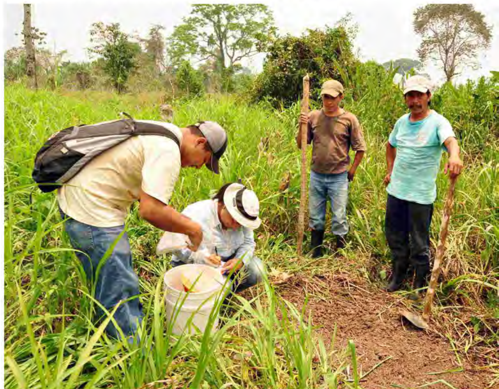
Toma de muestras de suelo, para la realización de estudio de Capacidad de Uso de la Tierra -ECUT- para futuro proyecto de producción de arroz - Pueblo Nuevo, Ixcán, El Quiché - 25-05-2013
